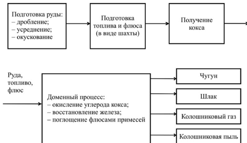
Рис. 2.1. Схема процесса получения чугуна
