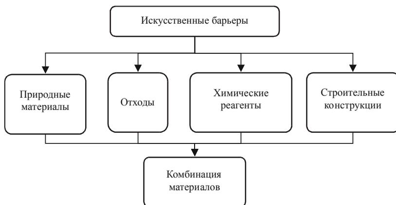
Рис. 7.2. Материалы, используемые для создания искусственных геохимических барьеров [5]
