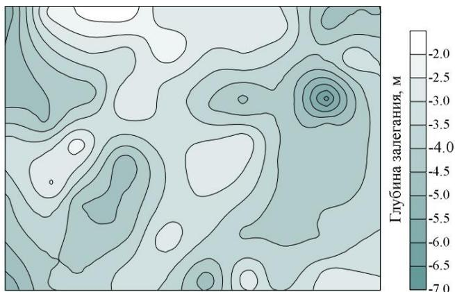
Рис. 7.1. Изолинии глубины залегания кровли чеганских глин.
