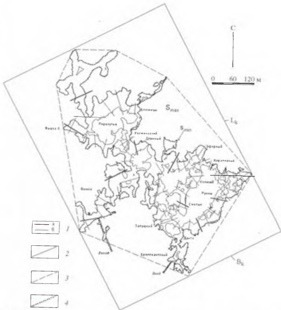
Рис. 9.10. Схема определения морфометрических параметров Кувшинской пещеры. 1 — направления съемки пещеры, выполненных по измерениям стационера в 1949 (а) и 1962 (б) гг. 2 — параметры приемы Корбеля; 3 — контур выпуклого многоугольника, имеющего пещеру ( S_{\text{вып}} ); 4 — контур выпукло вписанного многоугольника, описывающего пещеру ( S_{\text{впис}} )
