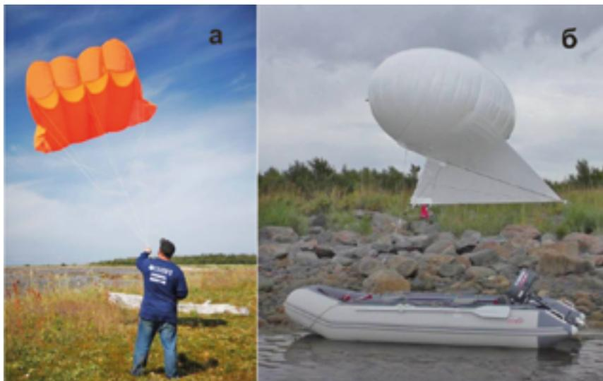
**Рис. 2.** Привязные беспилотные ЛА: а/ профессиональный воздушный змей Leader-4.8 (AviatoysTM, Уфа, Россия); б/ змейковый гибридный гелиевый аэростат Skyshot-2.0 (Allsopp Helikites Ltd.TM, Великобритания) и лодка Badger CL 3.4 (BadgerTM, Китай).
