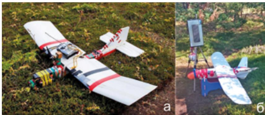
**Рис. 1.** FPV-система самолетного типа: а/ радиоуправляемая авиамодель Storm Chaser-1.8 (CrashTestHobbyTM, США), оснащенная FPV-оборудованием и пультом дистанционного управления JR 11X Zero-2.4 ГГц (Япония); б/ авиамодель Talon-2.02 и панельная приемная антенна на 1,2 ГГц (Video Aerial SystemsTM, США).
