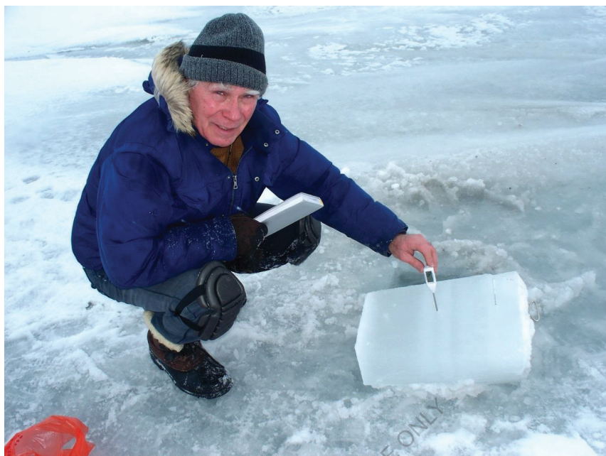
Измерение внутренней температуры образца льда электронным термометром.
