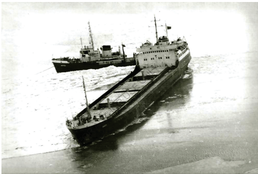
Рис. 14. Сухогруз «Баку» (водоизмещение 7 тыс.т.) выжат дрейфующими льдами за бровку ВКМСК на мелководье, на расстояние 10 км (фото автора).
