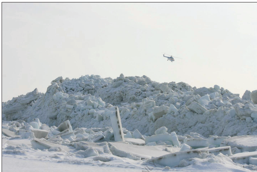
Измерение максимальной высоты стамухи с помощью вертолетного высотомера.
