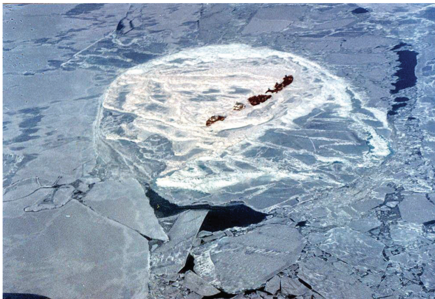
Кольцевая стамуха, образовавшаяся вокруг останков затонувшего на мелководье судна.
