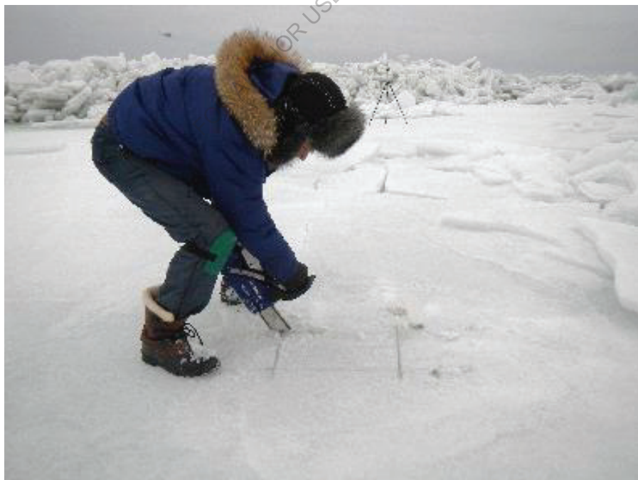
Вырезание образца для испытаний на прочность.
