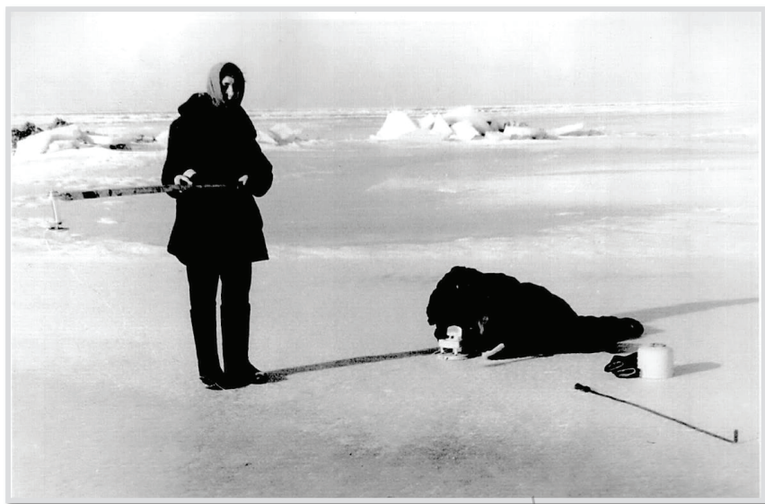
Рис. 17. Измерение альбедо каспийских льдов.
