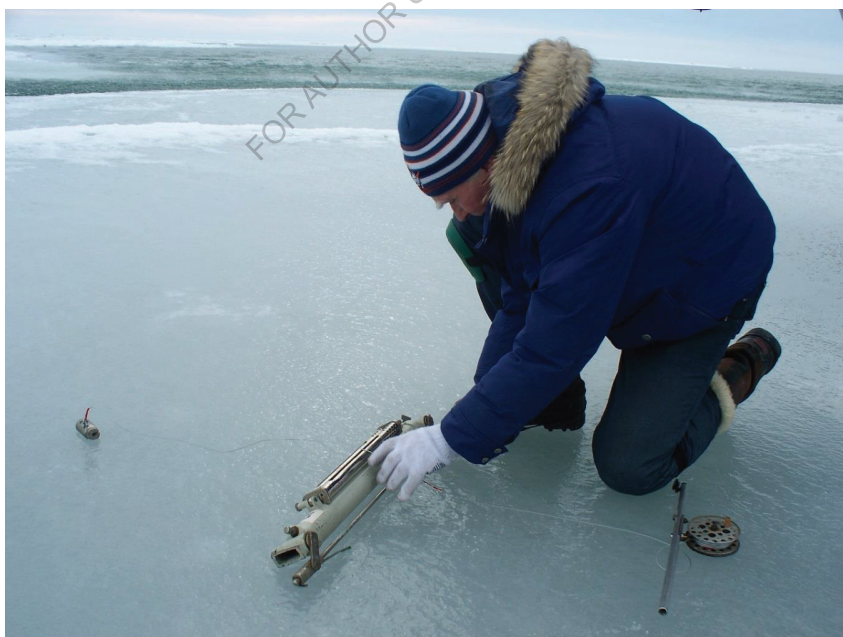
Подготовка морского батометра Нансена к спуску под лед.
