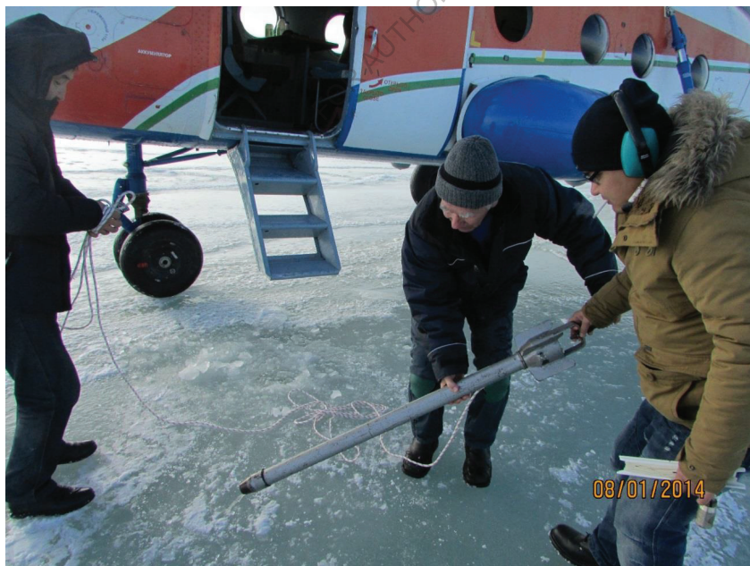
Работа с грунтоотборной трубкой ГОИНа.
