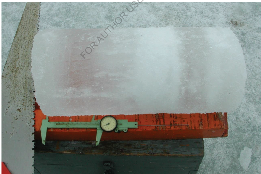
Высверленный с помощью кольцевого ледового бура керн льда.
