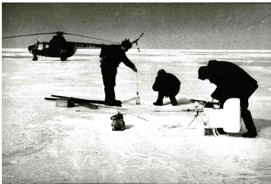
Измерение подледных течений на Северном Каспии со льда, с помощью морских буквопечатающих вертушек БПВ-2.
