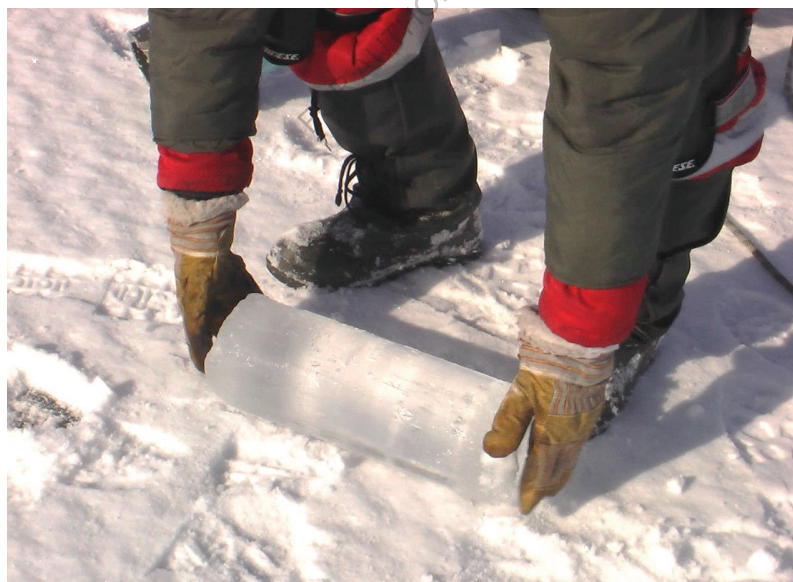
Рис. 114. Кольцевым буром вырезан керн.
