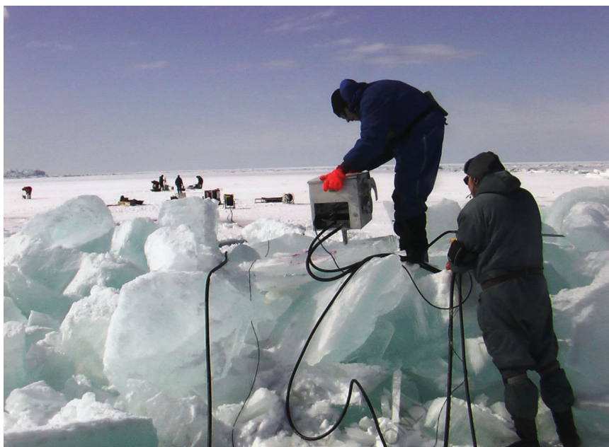
Рис. 80. Работа с термобуром (фото автора).
