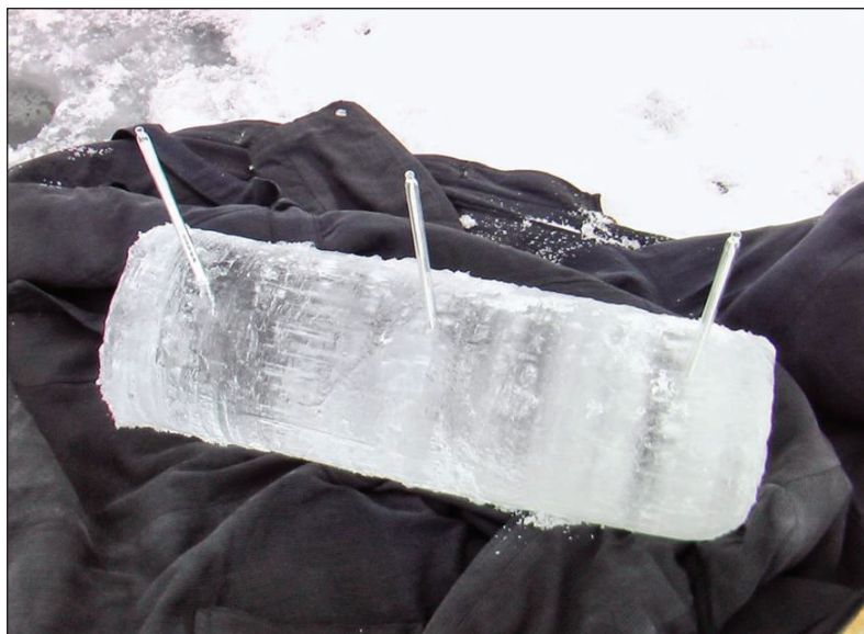
Рис. 113. Измерение температуры по слоям в керне слоистого льда, состоящего из чередующихся полупрозрачных и непрозрачных слоев.
