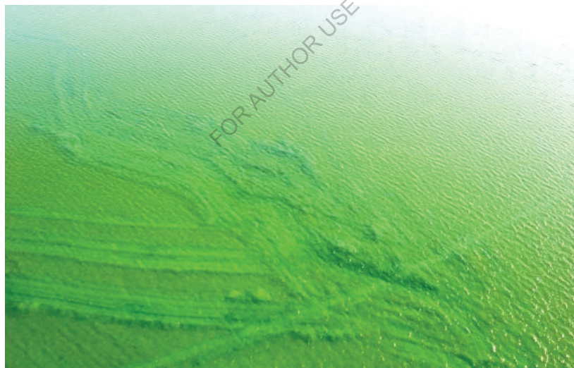
Рис. 105. Борозды выпаживания (вид с вертолета). В нижнем правом углу видна впадина, продавленная в грунте стамухой (фото автора).
