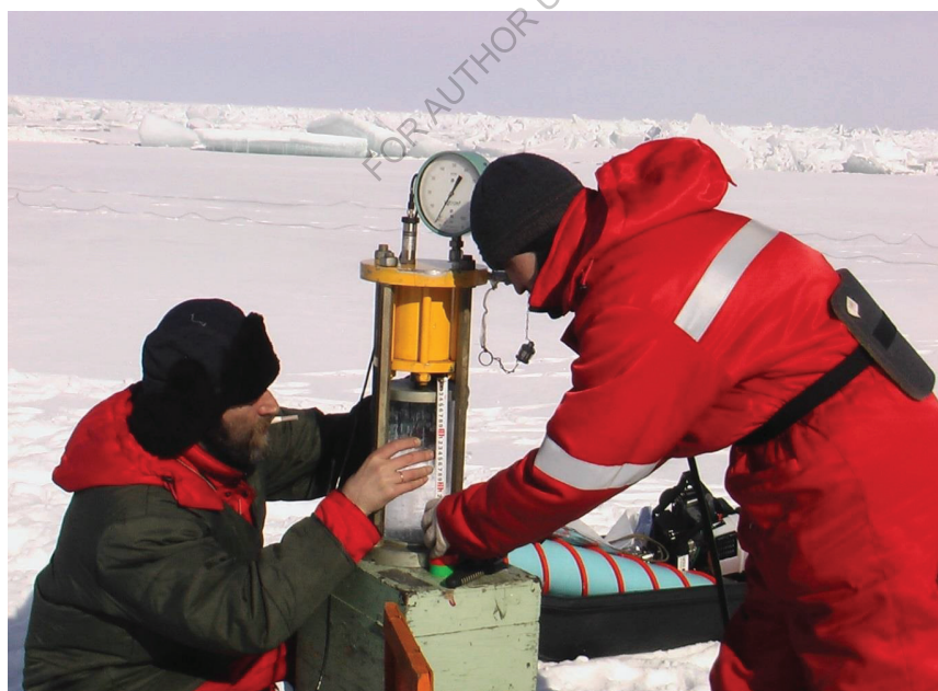
Рис. 81. Измерение прочностных характеристик образцов льда in situ (фото автора).
