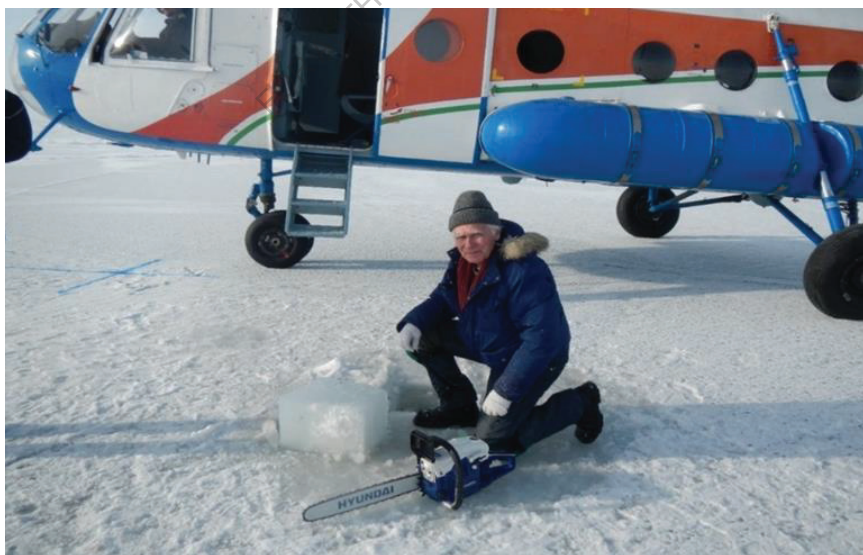
Рис. 31. Образец однородного, непрозрачного, матового льда, образовавшегося из внутриводного, взятый из замёрзшей полыни (фото автора).
