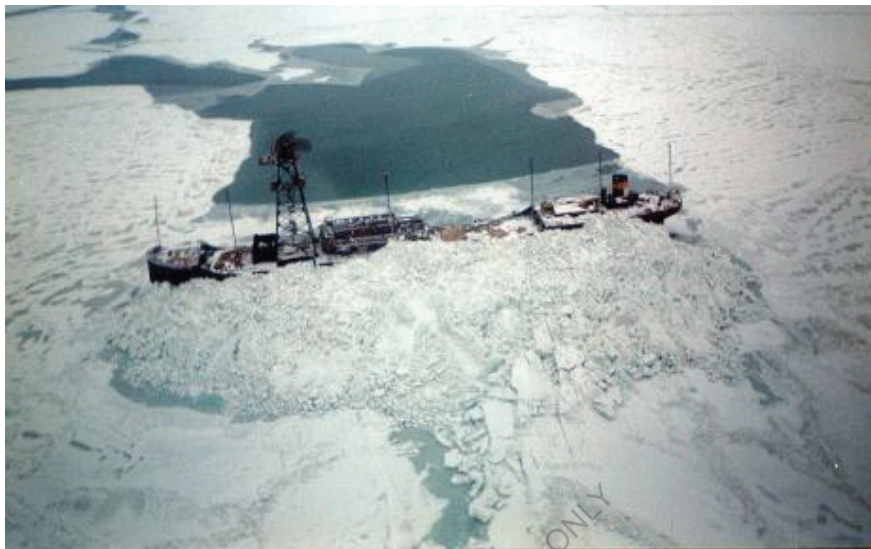
Мощная стамуха, образовавшаяся по борту сидящего на грунте старого судна.
