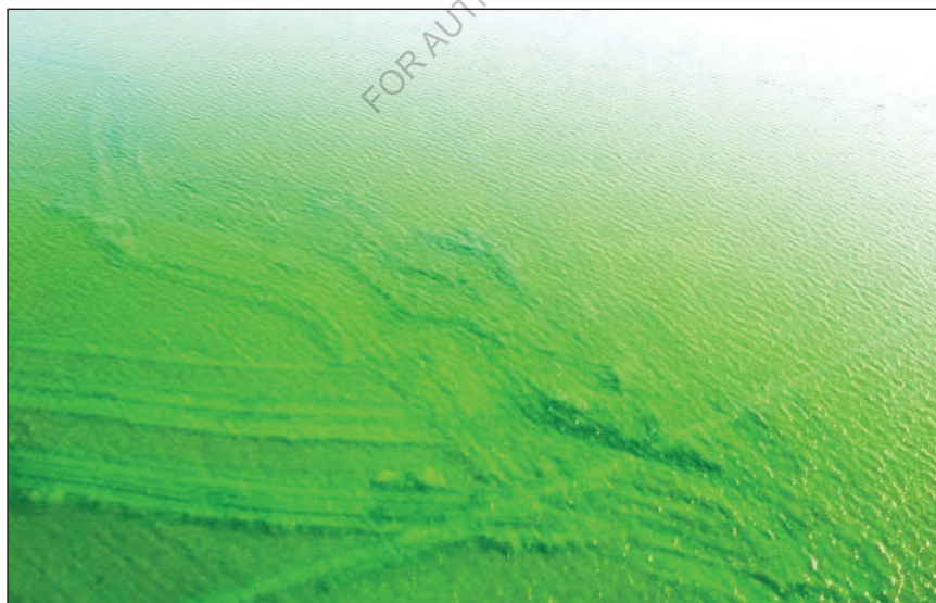
Рис. 65. Борозды выпайвания. Вид с вертолета. Справа, в нижней части снимка видна впадина, образовавшаяся в грунте на месте стамухи (фото автора).
