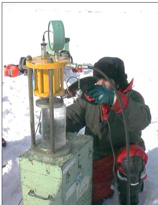
Рис. 115. Испытание очередного образца льда на прочность.
