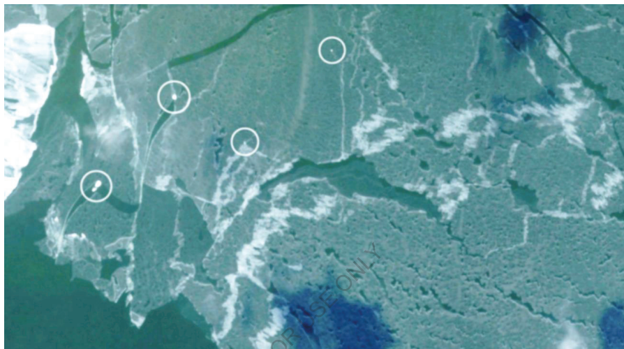
Рис. 71. Начальный период льдообразования на мелководье. Глубина моря 1-2 м. Поля тонкого ниласового льда при подвижках образуют подсовы. Торосов нет. Однако на стыках льдин, в результате взаимодействия с дном, образуются небольшие «осенние» стамухи.
