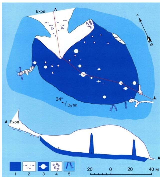
Рис. 2. План и разрез Аскынской пещеры [Смирнов, Соколов, 2002; Гареев, 2004] (1 – лед; 2 – глина; 3 – ледяные сталактиты, сталагмиты и колонны; 4 – камни; 5 – трещины)
