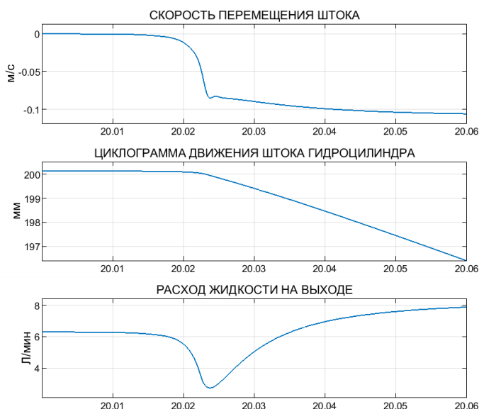
Рис. 6. Переходные процессы при переключении распределителя из среднего положения в крайнее правое (осциллограф №2).
