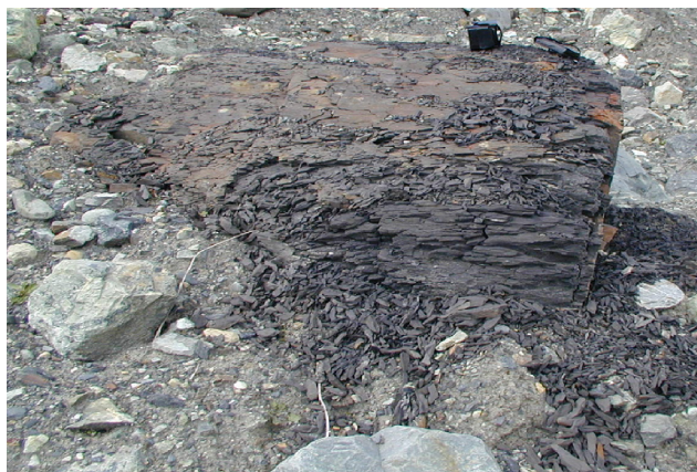
Рис.3. Разрушение тектонически-раздробленного сланца из зоны многолетней мерзлоты в результате оттаивания (ледово-каменный завал в районе селения В. Кани).
