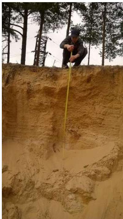
Рис. 1. Измерение высоты обнажения
