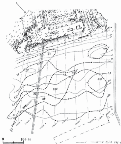
Рис. 2. Общие черты деформации подводного склона в пределах балки Куцей за период 09.2010 – 12.2011 гг. Изобаты: 1 – 2010 г.; 2 – 2011 г.; 3 – пространственные границы наиболее крупных положительных аккумулятивных форм (валов); 4 – максимальные значения положительных деформаций дна, м
