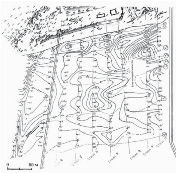
Рис. 1. Схема вертикальных перестроек подводного склона балки Куцей в зоне влияния терминалов за период 2007–2010 гг.
