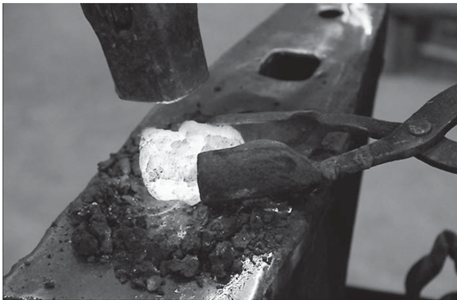
Рис.4. Проковка крицы после восстановительного процесса в горне при температуре 1320°С в течение длительного времени
