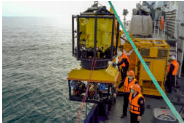
Спуск телеуправляемого необитаемого подводного аппарата.
