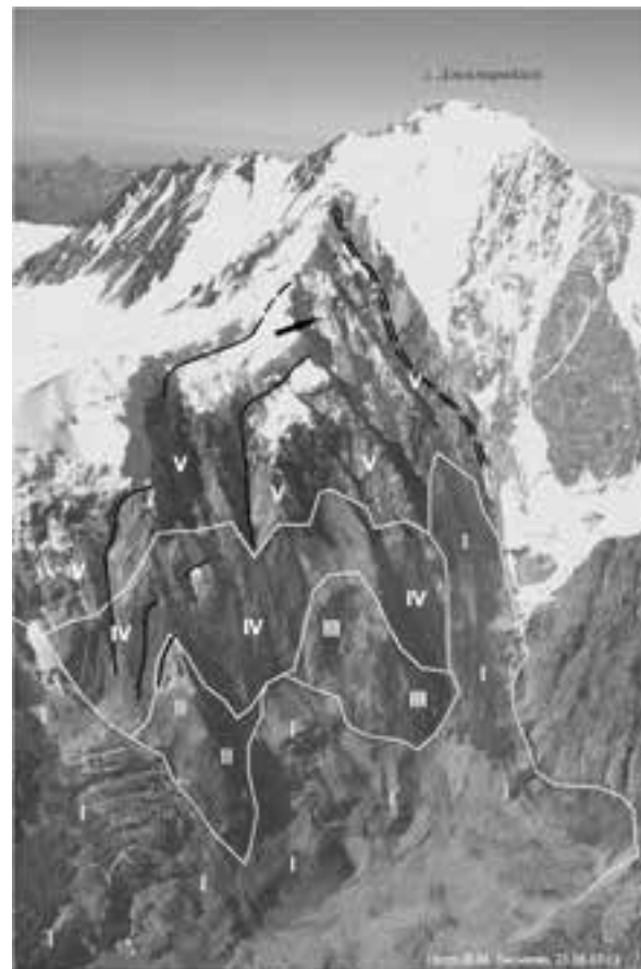
Условные обозначения: I — трещина отседания II — линия контакта, ограничивающего с запада толщу сильно трещиноватых вулканогенно-осадочных пород III — участок формирования многофазного обвала в 2002 году
