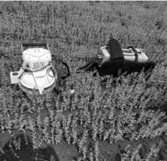
Рис. 3. Портативная система измерения почвенного газообмена фирмы LI-COR на поле с посевами льна. 26.04.2023 г.
