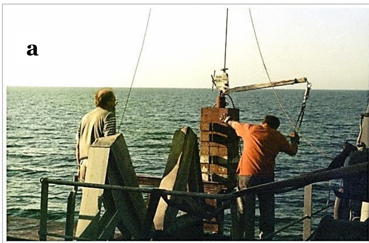
Отбор проб грунта осуществлялся как с помощью большой грунтоотборной трубки (а), так и большим дночерпателем «Океан» (б)
