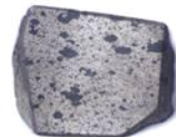
Фото 3. Массивная брекчиевидная сульфидная медно-железная руда в элювиальном серпентинитке мазинского типа. Нижнеамурское месторождение
