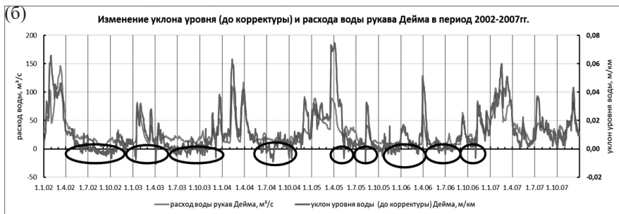
Рис. 3 Изменчивость уклона водной поверхности и расхода воды в рукавах Нижняя Преголя (а) и Дейма (б) в период 2002–2007 гг. (с выделенными расхождениями)
