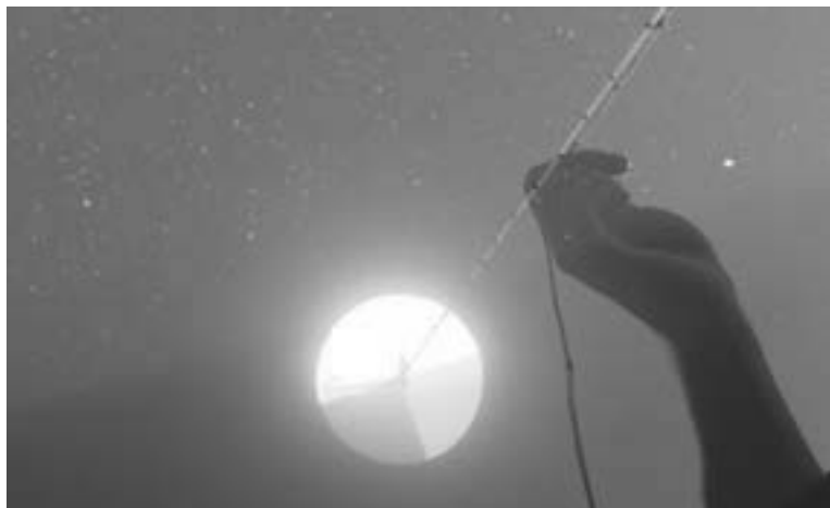
Рис. Общий вид диска Захарова (измерение на глубине 2 м в озере Тургояк)
