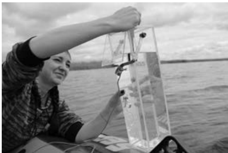
Рис. 3. Самодельный батометр системы Паталаса
