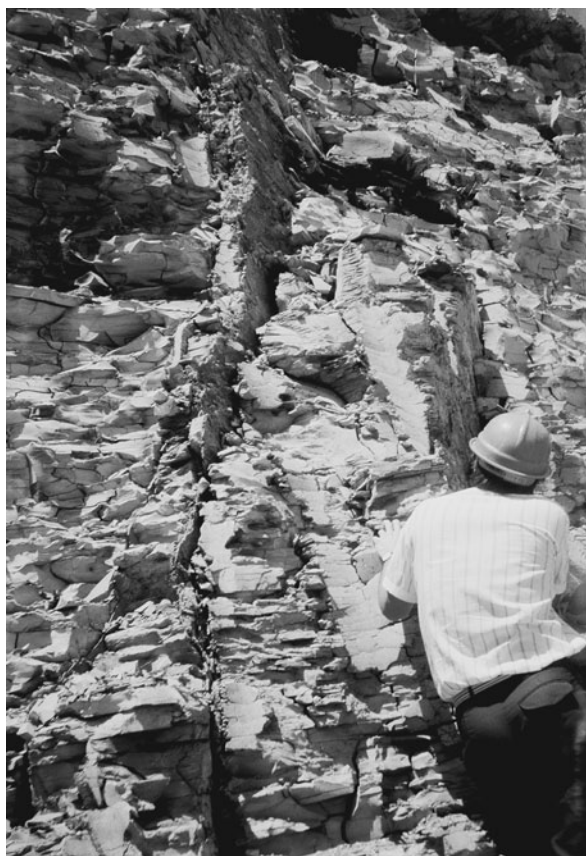
Рис. 3. Трещины в зоне экзоконтакта, выполненные гипсом и кальцитом
