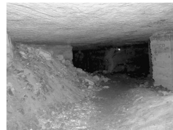
Рис. 10. Верхняя выработка. Типичный вид. Вдоль стен отсыпаны отвалы из некондиционного материала с большим содержанием тырсы
