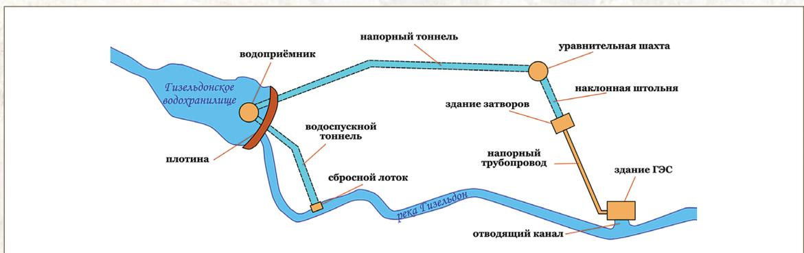
Рис. 139. Схема расположения сооружений Гизельдонской ГЭС [123]
